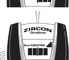
Continúe deslizando la herramienta. Cuando se localice el centro de la viga se muestran tres barras en el Signal Strength Indicator (Indicador de Fuerza de la Señal), y las cuatro barras centrales, la pantalla CENTER, y el Spotlite® todos se iluminarán, y la bocina sonará.
